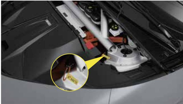
3. Mit dem oben rechts unter der Motorhaube befindlichen Service-Trennschalter (MSD) für Niederspannung lässt sich das Hochvoltssystem automatisch deaktivieren.
